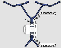
Appliquez deux gouttes d'huile sur le filetage des goujons et entre le corps de l'écrou et l'embase. Évitez de mettre de l'huile sur la face de l'écrou, les roues et le tambour de frein.
