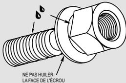
Serrez à la main les deux écrous des positions supérieures d'une jante à 8 trous et des positions, supérieure et inférieure, d'une jante à 10 trous. Serrez à la main les écrous restants. Ensuite, serrez tous les écrous à 50 lb-pi en suivant la séquence illustrée à l'étape 6.
