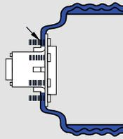
Les roues étant d'équerre avec le moyeu, montez la roue interne et la roue externe aussi loin que possible sur le taquet de guidage. Assurez-vous que les deux valves sont accessibles.
