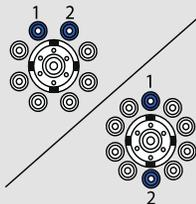
Terminez la pose en serrant tous les écrous selon la séquence illustrée et le serrage recommandé de 450-500 lb-pi. Après l'installation, faites tourner les roues pour vous assurer que le tambour reste bien assis contre la face du moyeu.
