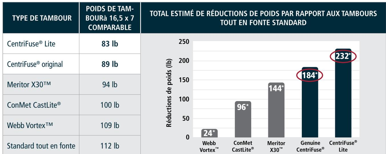
\*Total estimé des réductions de poids pour un camion semi-remorque type avec 4 essieux et 8 tambours.
